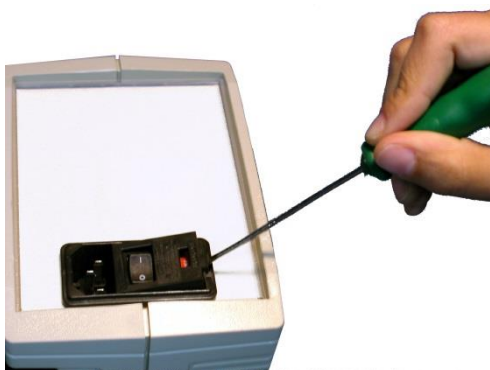
Figura 2. Abrir la puerta del porta-fusibles.
