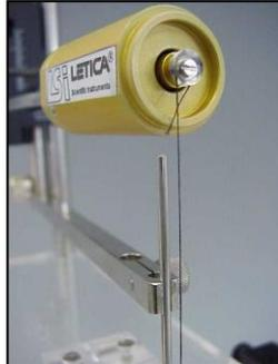
Figura 21. Hilo atado al transductor.
