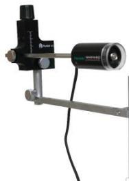
Figura 17. Conjunto Transductor Microposicionador.
